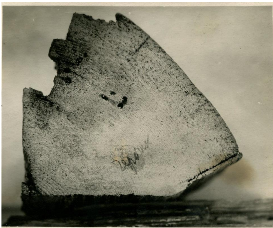
Фото 2. Образец древесины, пораженной жуками-точильщиками
